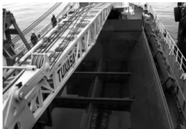
浚渫用クレーンブームと300 \text{m}^3 ホッパー(泥槽)
