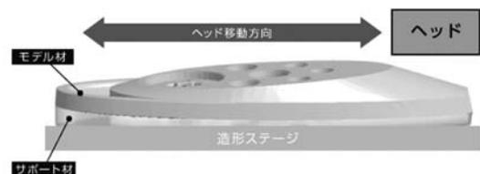
図-3 モデル材とサポート材<sup>3)</sup>
