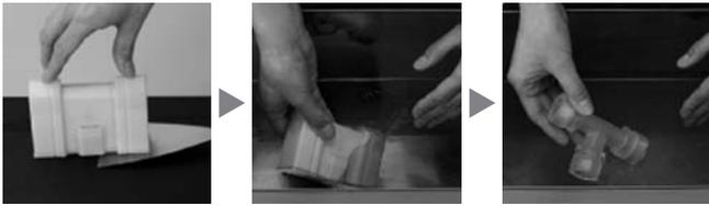
図-4 後処理状況(サポート材の除去)<sup>3)</sup>
