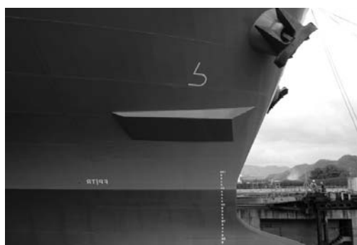
図3-3 ステップの実船への設置状況
