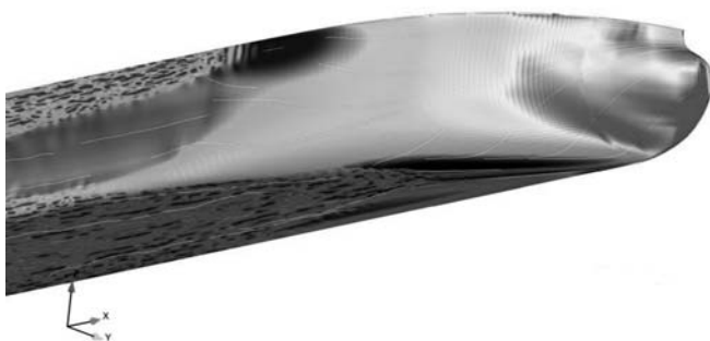
図-1 船体表面の渦度分布と限界流線
