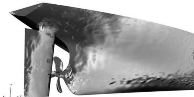
図-4 自航計算の瞬時場圧力分布
