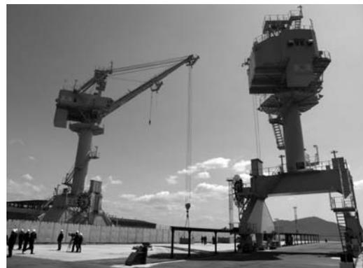
32トン(左)と10トン(右)の岸壁クレーン
