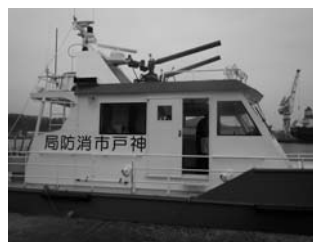
操舵室及び放水砲
