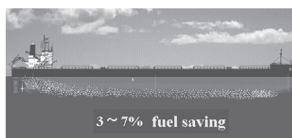
図-3 空気潤滑システムの概要と開発
