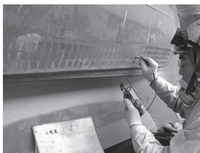
写真－2 船底外板の超音波による板厚計測
