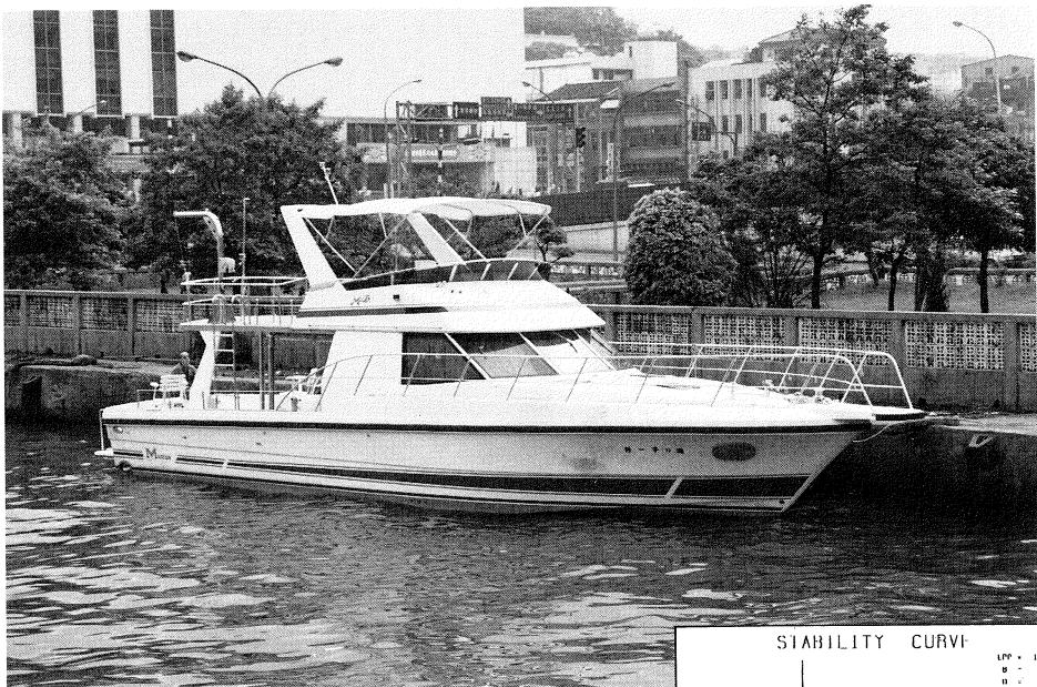
西表国立公園に臨む石垣市を基地とし、豊富なダイビングスポットを抱えたダイビングボート。フライングデッキを有し、重心が高目になりがちであるが、船の幅が大きく、ある程度の乾舷を有することなどから比較的復原力範囲が広い船となっている。
