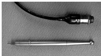
写真-2 5孔ピトー管と圧力変換器
