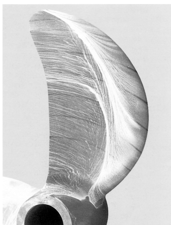
写真-3 ペイント法によるプロペラ翼面上の流れ
