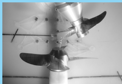
POD型プロペラの向きを変えたときの キャビテーション
