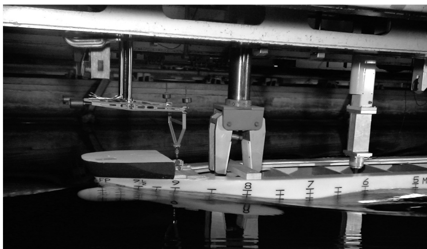
曳航試験のようす (船体前半部を見る)
