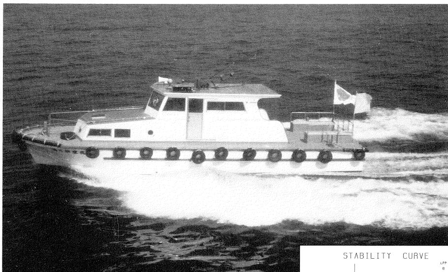
横浜港を船籍とし、東京湾内のウォーターフロント開発現場等を結ぶFRP製交通艇である。本艇の復原力曲線は、比較的本艇の乾舷が大きく、重心が低くなったことから、46度付近で最大復原てこを与える特徴ある形状を示している。
