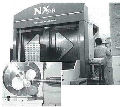
写真-2 模型プロペラNC切削装置
