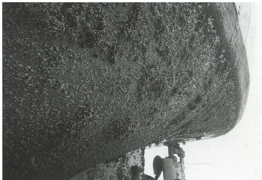
船舶の運航経済性向上をめざし、推進性能向上努力が長年に涉って続けられ優秀船型が開発されて来ました。推進性能は造船所にとり受注競争力の要の一つでもある事から、今後も推進性能向上努力は止む事はないと考えられます。しかしこの性能は自動車にたとえると、標準状態でのリッターあたり走行距離の様なもので、渋滞や悪路等多様な走行状態においてカタログ通りの性能の出ない事は、良く理解されています。船舶の場合、自動車の一般走行における状況に相当するもの、すなわち実際の海洋においては風浪による抵抗増加と船体外板に付着する
