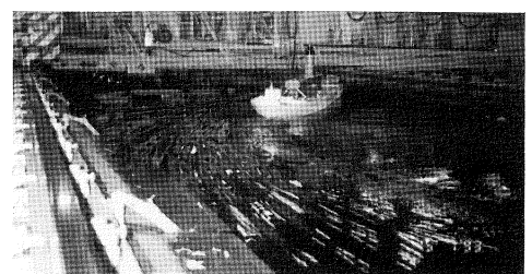
PMM試験装置による操縦性能試験
