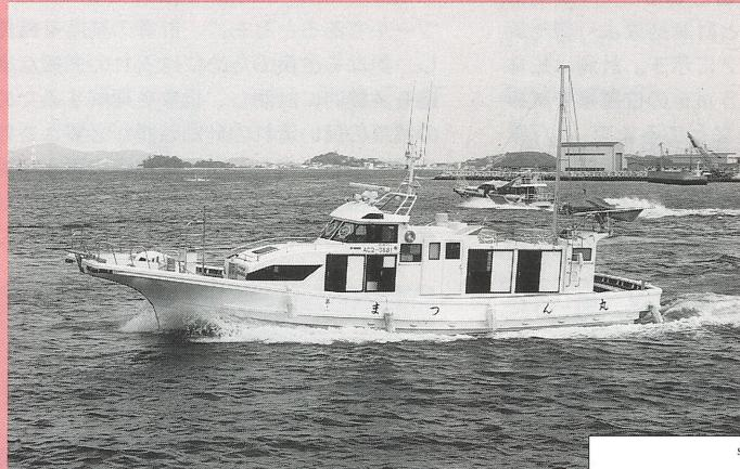
愛知県知多半島突端の師崎港を母港とし、遠州灘を主漁場とする小型遊漁兼用船である。この種の船としては型幅が広く、比較的大型船に属し、最大復原てこも50cmを越え、安定した復原性能を示している。
