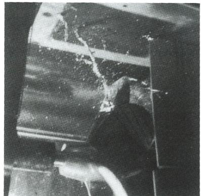
一天俄かにかき曇り、厚い雲の下から細長い漏斗がするすると降りて来て地面とつながったかと思うと猛烈な風を伴って、行く手にあるものを破壊しながら見る見る近づいて来る竜巻は自然現象の中でも大きな被害をもたらす恐ろしい現象です。最近は映画の主人公として登場しておりますし、房総方面では毎年のように被害が報告されています。竜巻は地面が激しく熱せられて盛んに上昇気流の生じるような不安定な気流の中に生じることが知られていますが、この竜巻と似た現象が、船尾の流れの中に発生する事があります。写真を見て下さい。プロペラの先端から細いパイプが突出し、船体に向かって伸びているのが判りますか。これは、現代芸術の置物ではありません。キャビテーションタンネル内に設けられた模型の後方に付けられて高速で回転する模型プロペラの様子をストロボカメラで撮影したものです。プロペラとハル（船体）とをつなぐ渦ということで、プロペラ、ハル、ポルテックス(P.H.V.)と呼ばれている船尾まわりの流
