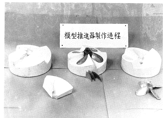
写真-2 昔のプロペラ製作工程
