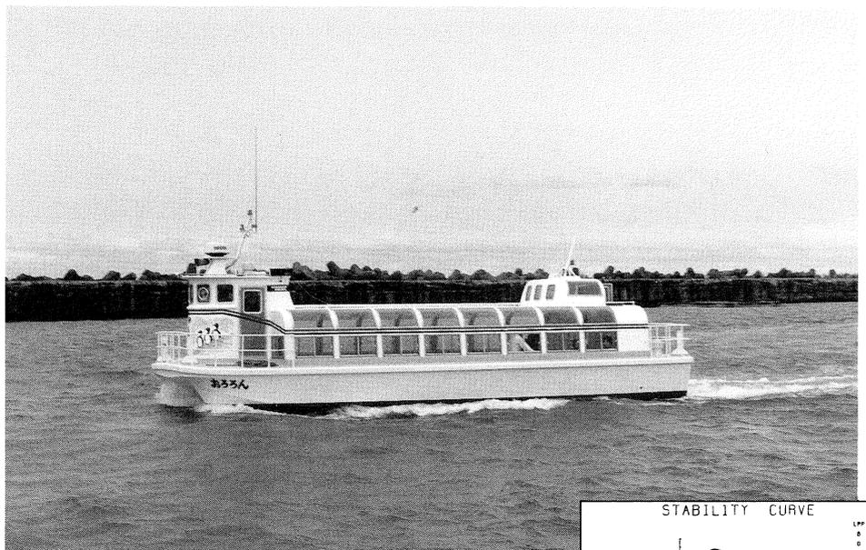
北海道苫前郡羽幌町天売島に就航した海底探勝船。本船は、水面下が双胴の船型であり、その復原てこ曲線は、おおそ双胴船に似た傾向を示している。傾斜角20度付近で最大復原てこ約1.1mを示す。また、姉妹船に「かもめ」があり、焼尻島に就航している。
