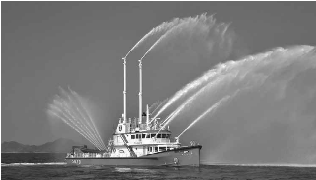
全門放水及びギヤー式集合放水管
