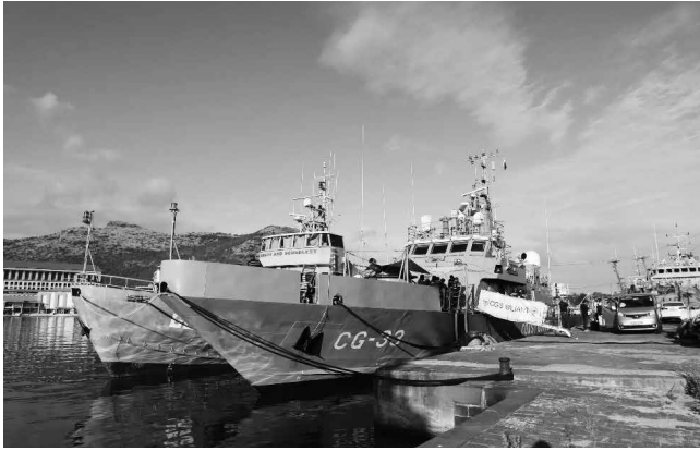
沿岸警備隊で2番目に大きなCG-33バリエント。 2017年インドのゴア造船所建造。長さ48m、幅7.5m、喫水2m、 排水量259t、最大速力35kn、主機関MTU3648HP×3基、 ウォータージェット推進、航続距離2800km（12kt時）。
