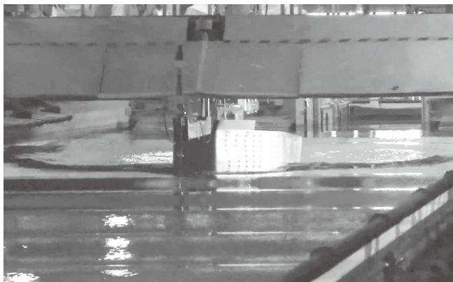
図9 波の中を進む模型船の様子
