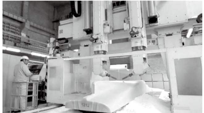
図3 模型船のNC切削の様子
