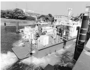
油圧クレーン ダイバー用梯子
