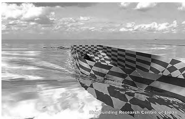
船が作り出す波を再現した数値流体シミュレーション
