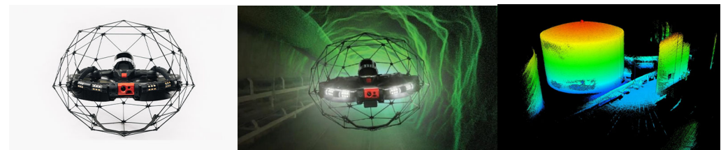
プラント・橋梁等の点検ドローンの活用
