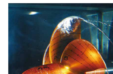
騒音や振動、エロージョンの原因を探るキャビテーション試験
