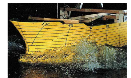
波の中を進む性能を知る波浪中試験
