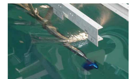
プロペラ単独性能試験 省エネルギーデバイス付きプロペラやダクト付きプロペラの試験にも対応
