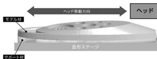
図-3 モデル材とサポート材 3)
