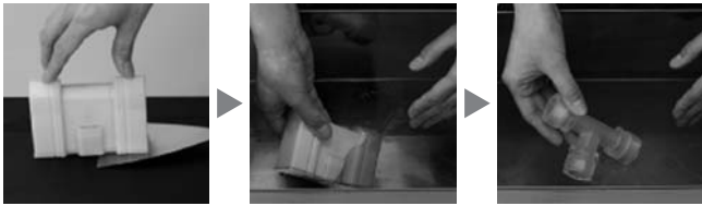
図-4 後処理状況(サポート材の除去) 3)
